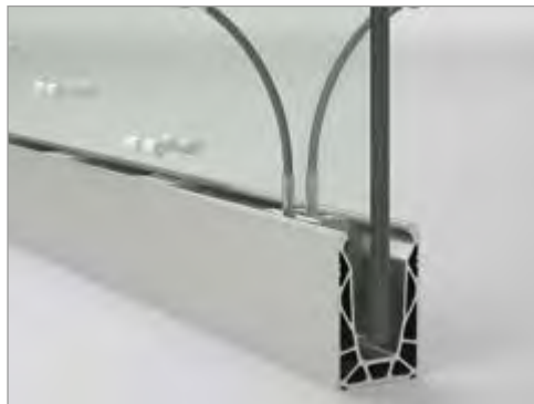
4 Inserción de los rodillos de POM. Los rodillos garantizan una mejor distribución de la carga en la interfaz vidrio/pinza/perfil, maximizando el rendimiento del sistema.
