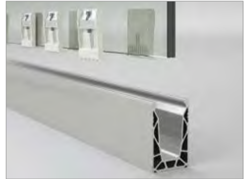
2 Montaje pinza, intereje de las pinzas en el vidrio 250 mm - 4 pinzas/m
