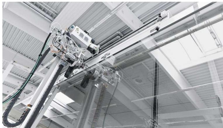
*Vidrios con dimensiones de hasta 3,2m x 15m se producen en un proceso altamente automatizado en la línea de vidrio aislante por el procesador de vidrio Sedak.*
